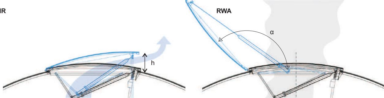
Denní větrání je možno standardně otevírat na výšku 300mm. Na základě konzultace lze výšku upravit až na 500mm. Pohon denního větrání může být pneumatický nebo elektrický (24V / 230V).
