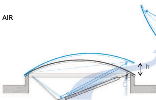
Denní větrání je možno standardně otevírat na výšku 300mm. Na základě konzultace lze výšku upravit až na 500mm. Pohon denního větrání může být pneumatický nebo elektrický (24V / 230V).
