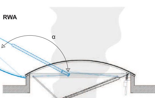
Táhla klapku otevřou až do polohy 140°. Píst je ovládán pneumaticky a to buď do polohy otevřeno nebo otevřeno/zavřeno. Uložení pístu se může lišit.
