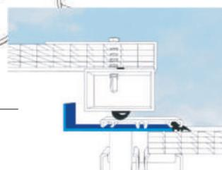
Při řešení klapky ve vrcholu je nutné klapku nasadit až na nosnou konstrukci. Sestava je dotěsněná gumovým těsněním
